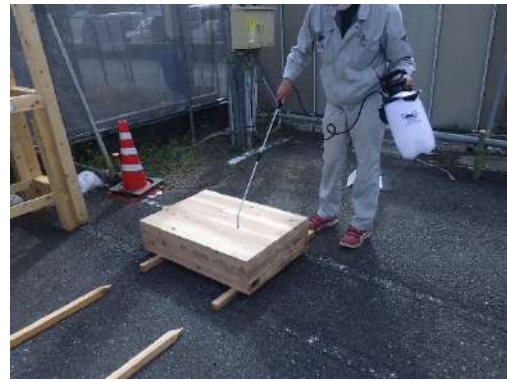
写真 試験体作成（撥水材塗布）状況
