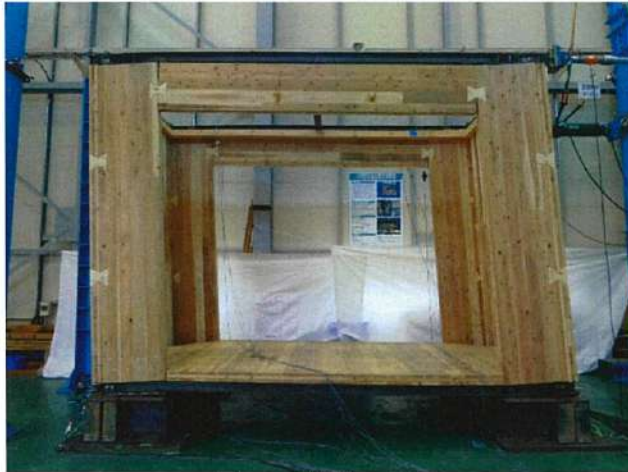
写真2 試験体の状況 試験体：ユニット 最大荷重時
