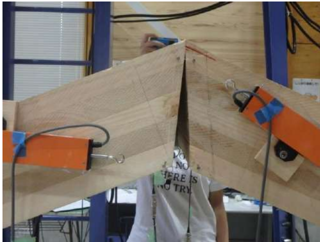
接合部の破壊状況（前側）
