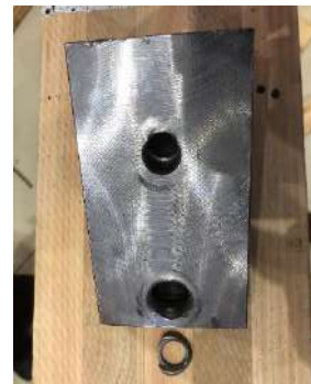
実験終了後の金物薄肉部の 破壊
