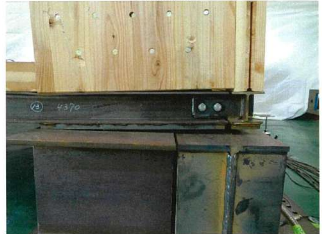
写真5 試験体の状況 試験体：ユニット 最大荷重時
