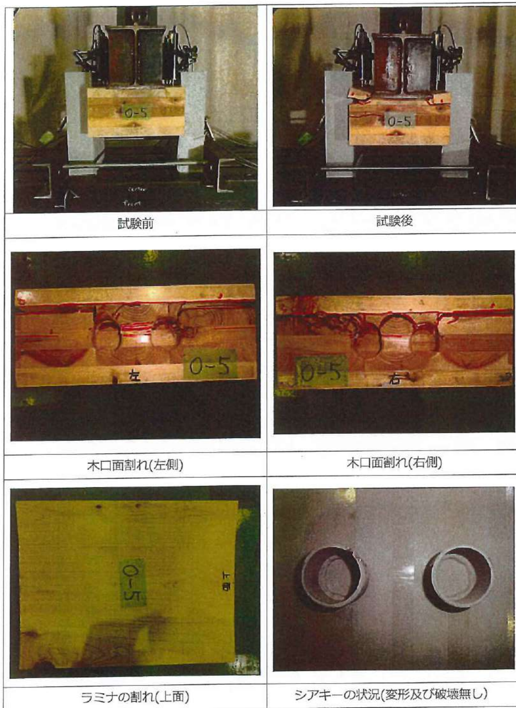
写真 6.5 破壊状況 (試験体 No.5)
