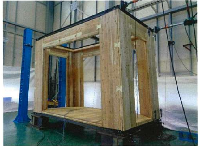
写真3 試験体の状況 試験体：ユニット 最大荷重時
