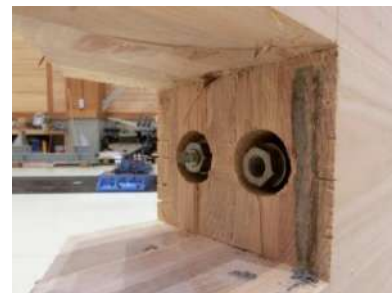
実験後のボルトの破断（解体後）
