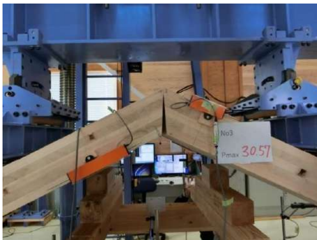
接合部の破壊状況（前側）
