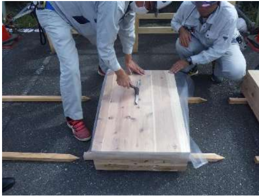
写真 試験体作成（シート張り）状況
