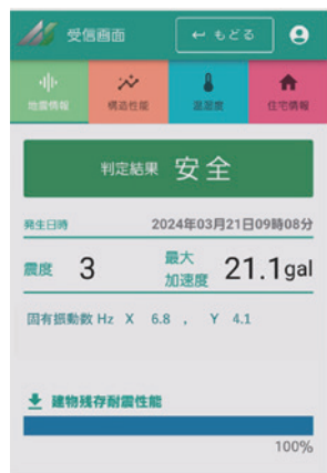
図3 利用者のスマホで表示されるAiシル®の診断結果の例※5
